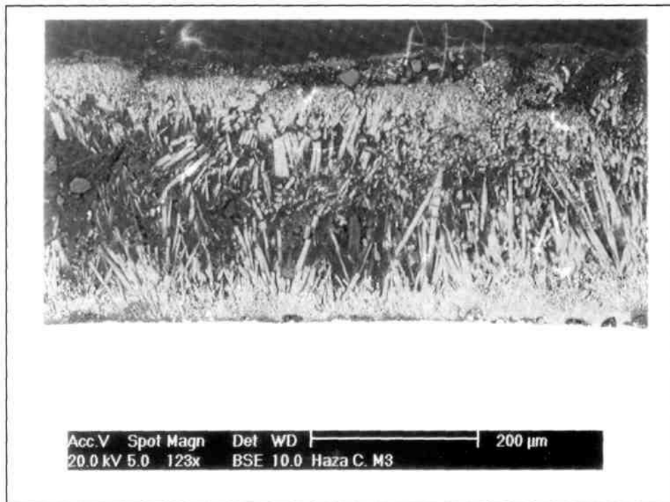
FIG. 3 Fotografía de MEB de la capa de la Fig. 2, donde se muestra la estructura de los cristales.
