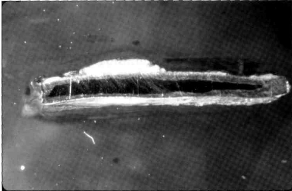
FIG. 2 Sección metalográfica de un fragmento de moneda donde se muestra la capa verdosa de cloruros de Cu sobre la superficie de plata.
